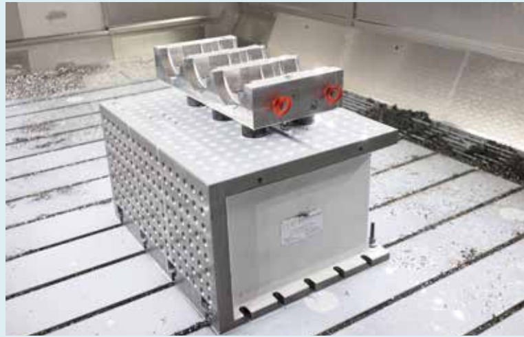
Auch die von Kestermann selbst produzierten und auch als Eigenprodukt vermarkteten Spannwürfel vermessen die Zerspaner sehr genau und übernehmen die exakten Ist-Werte ins System. Bild: Pergler
