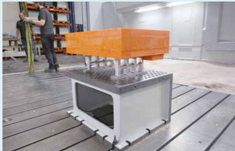
Auch die Rohlinge werden exakt vermessen und als virtuelle Zwillinge im System. So ist sichergestellt, dass die Programmierer mit Echtzeiten simulieren können und die Resultate aus der Software auch exakt der Realität entsprechen. Bild: Pergler
