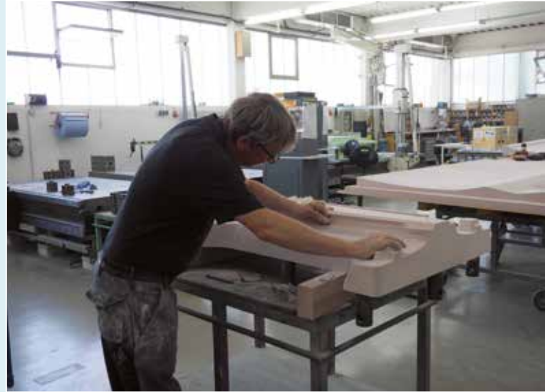
Nach dem Fräsen ist nur wenig Nachbearbeitung erforderlich.
