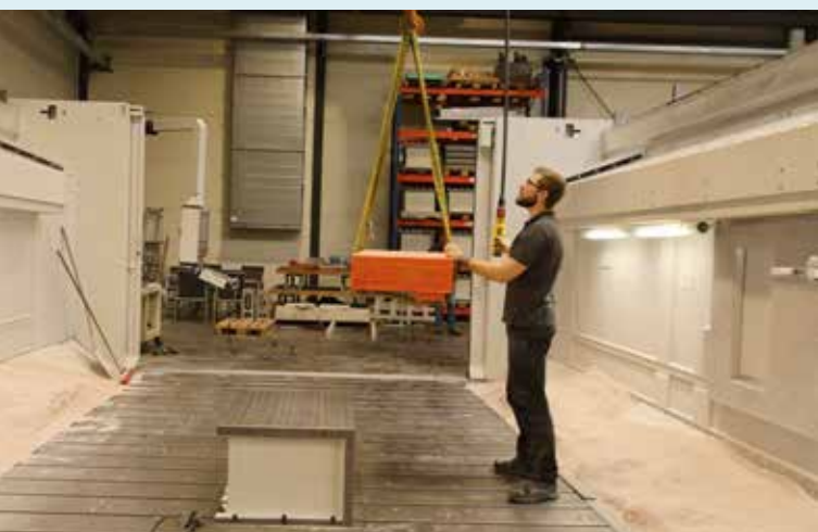
Das Spektrum der zu fertigenden Teile ist bei Kestermann sehr weit gesteckt. Von 100 x 100 x 100 mm bis hin zu 7000 x 3500 x 1750 mm reicht die Spanne der Dimensionen, die die Modell- und Formenbauspezialisten aus Emsdetten bearbeiten können. Bild: Pergler
