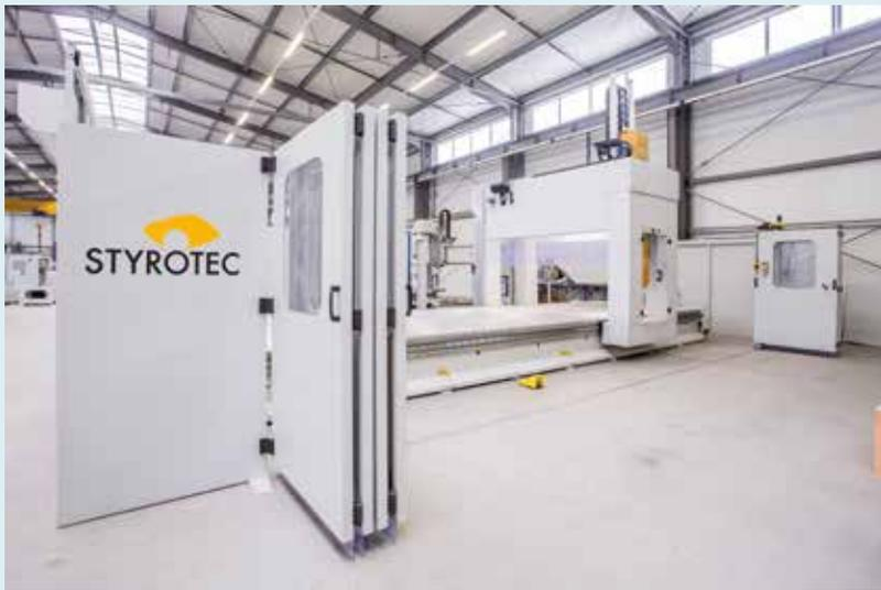
Portalfräsmaschine FS 10 GT mit innovativem, thermosymmetrischem Doppelportal für die effiziente Bearbeitung von komplexen Werkstücken
