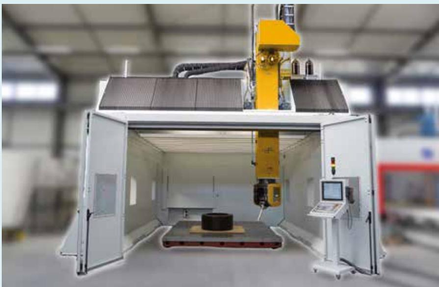
Großvolumige, schwere Gantry-Maschine FS 15 VT-M (4 m x 3,7 m x 2,5 m) mit leistungsstarkem Gabelkopf, 50-kW-Spindel und HSK-A-100-Aufnahme
