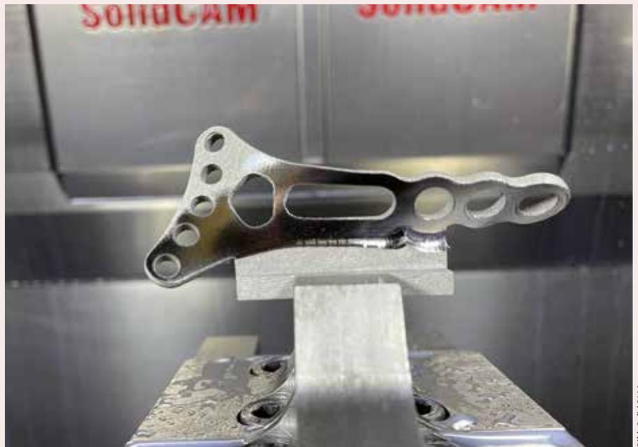
Eine Knochenplatte als Beispiel aus der Medizintechnik: Die Software-Experten von SolidCAM Additive streben eine durchgängige Verarbeitung der Daten vom CAD-Programm über den 3D-Druck bis zur Programmierung der Bearbeitungsmaschinen an.
