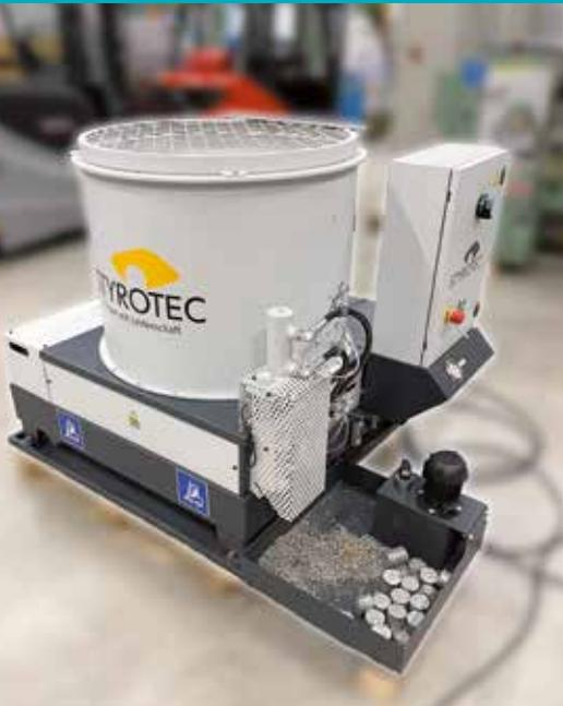
Hydraulische Spänepresse zum Brikettieren von Aluminium-, Guss- und Stahlspänen
