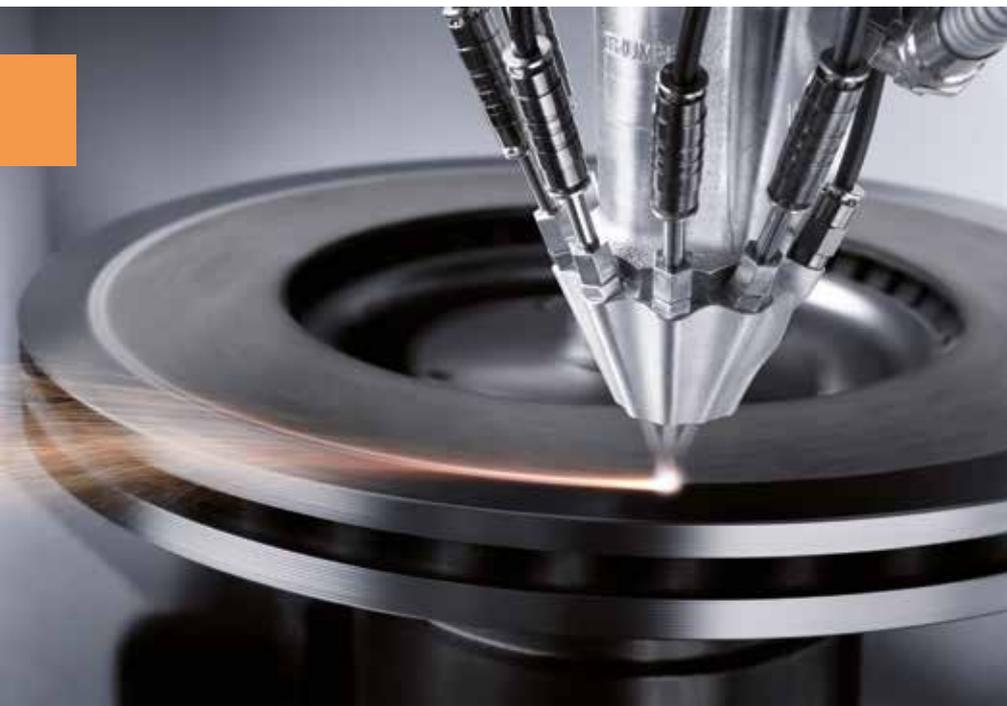
Durch das innovative Design der Pulverdüse im Metall-3D-Druck wird die Herstellung von emissionsarmen Brems Scheiben noch effizienter und prozesssicherer
