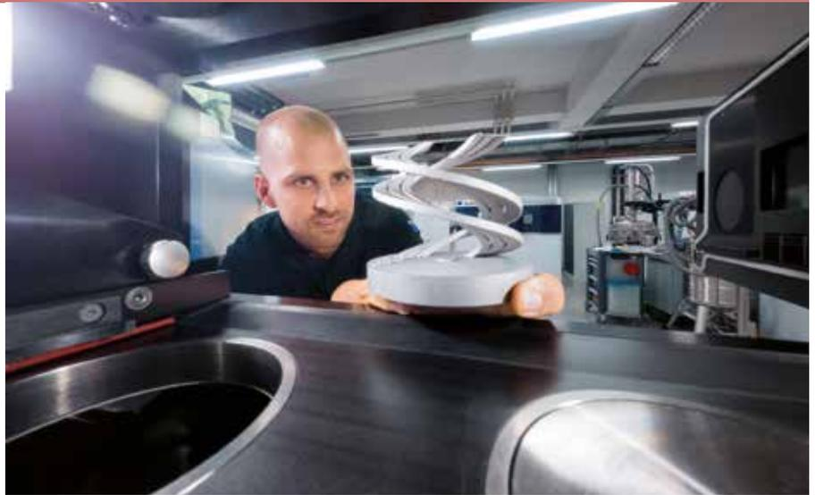
Anwender drucken mit TruTops Print Bauteile mit extremen Überhängen von bis zu 15 Grad ohne Stützstrukturen. Bild: Trumpf
