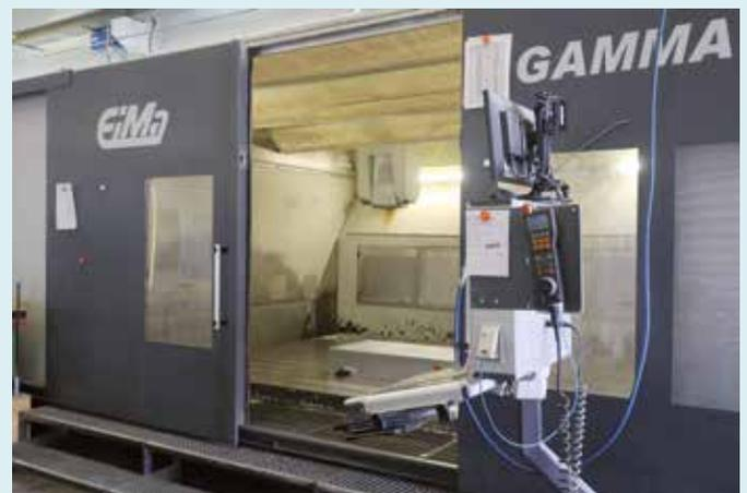
*Der Betrieb hat sich in den vergangenen Jahren mit der Lohnfertigung von Bauteilen in Klein- und Kleinserien ein zweites Standbein geschaffen. Die Spezialität bei Hawk sind mittelkomplexe bis komplexe Werkstücke. Fräsen können die Zerspanungsexperten bis zu einer Dimension von 3,5 x 2,5 x 1,5 m.*
