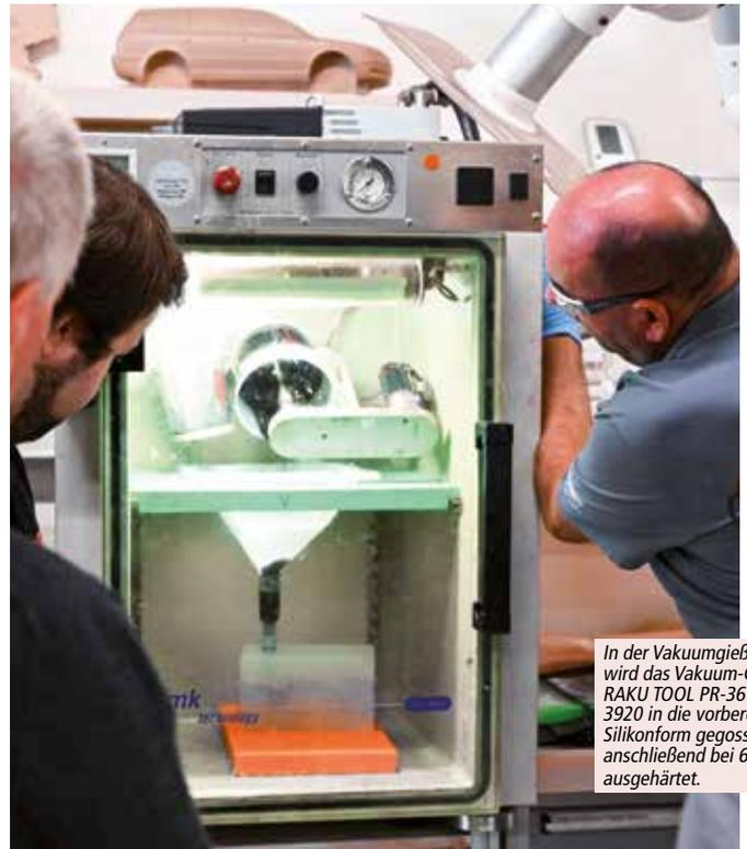
In der Vakuumgießanlage wird das Vakuum-Gießharz RAKU TOOL PR-3612 / PH-3920 in die vorbereitete Silikonform gegossen und anschließend bei 60 °C ausgehärtet.
