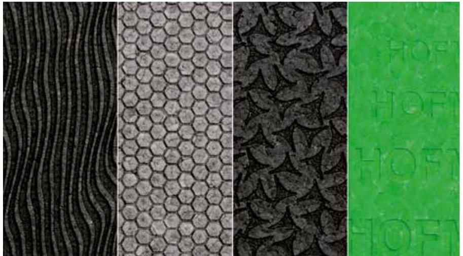
Filigrane Oberflächenstrukturen von Partikelschaumobjekten, hergestellt mit einem patentierten Verfahren der BEAD.MACHINE
