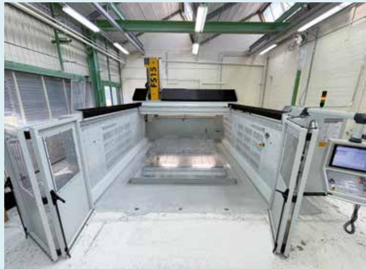
Oben geführte Gantry-Maschine FS 15 VT-5 mit Arbeitsraumabdeckung und Absaugsystem
