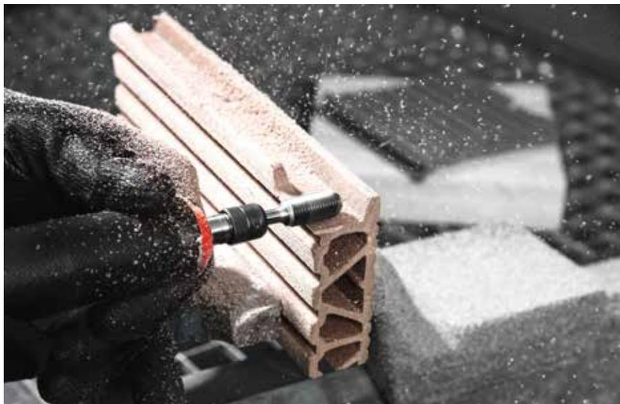
Wo HSS- und Hiebfräser schnell klein beigegeben, überzeugt der Raspelfräser Wood von LUKAS durch seine außerordentlich lange Standzeit. Bilder: Lukas-Erzett
