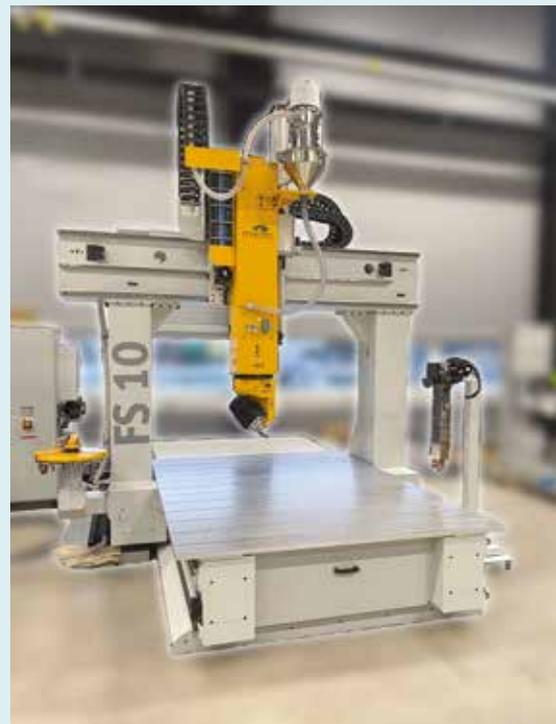
Die Portalfräsmaschine FS 10 ST mit Hybrid-Technologie ermöglicht das Fräsen und Drucken in XXL in einem System
